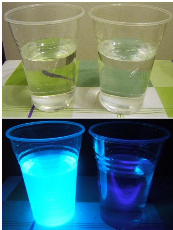
Figura 2.- Arriba: dos vasos, el de la izquierda con agua tónica y el de la derecha con agua del grifo. Abajo: los mismos vasos, pero cuando son iluminados con luz ultravioleta.
